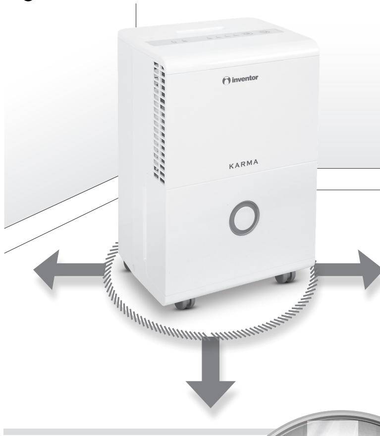
1) Ne bloquez ni ne restreignez le flux d'air autour de l'appareil. Assurez-vous que les grilles d'échappement de l'entrée d'air ne sont pas obstruées. Autoriser 30cm de dégagement autour de l'appareil.
