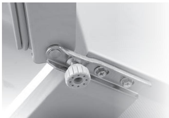
**3.** Δημιουργήστε ελαφρά κλίση ώστε να έχετε πρόσβαση στο μπροστινό κάτω στήριγμα. Ξεβιδώστε τις βίδες που βρίσκονται κάτω αριστερά ή δεξιά (ανάλογα με την αρχική τοποθέτηση της πόρτας) και αφαιρέστε το πόδι από την αντίθετη πλευρά. Μόλις αφαιρεθούν οι άνω και κάτω βίδες και το πόδι στήριξης, η πόρτα θα απελευθερωθεί τελείως.
