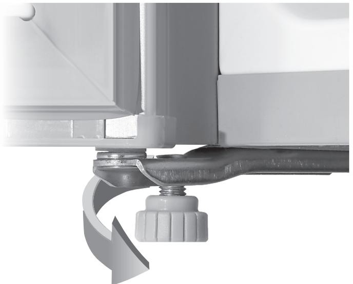
**7.** Infine serrare saldamente la cerniera inferiore e regolare nuovamente il piedino sul lato opposto per una corretta livellazione.
