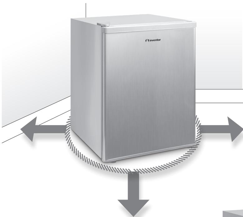
**1.** Permettre une ventilation suffisante autour de l'appareil. L'extrémité arrière de cet appareil doit se tenir contre un mur permettant une ventilation suffisante comme suit :
