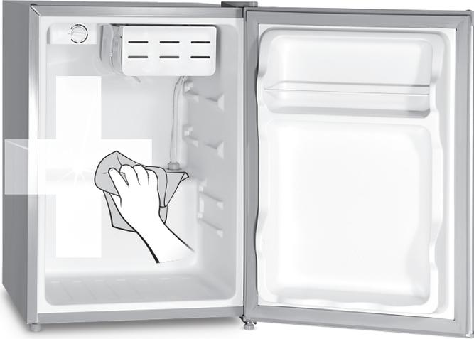
Vor der Reinigung des Gerätes den Stecker aus der Steckdose ziehen und alle Regale entfernen.
