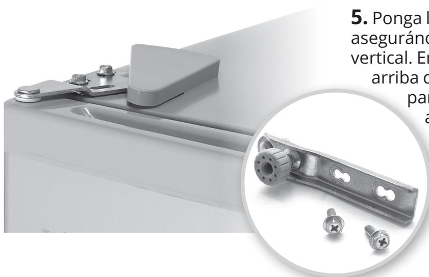
**5.** Ponga la puerta en el lado deseado, asegurándose de que está en posición vertical. Enrosque los tres tornillos de arriba de la bisagra. Inclínelo ligeramente para un mejor posicionamiento y atornille la bisagra de arriba en su sitio, y también enrosque la pata que sacó en el otro lado. Una vez terminado, acople el tapón de plástico de arriba.
