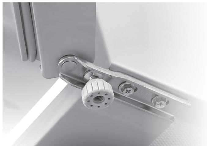
**3.** Leicht kippen, um Zugang auf den front Bodenhalter zu bekommen. Schrauben Sie die drei Schrauben unten links oder rechts (je nach der ersten Türinstallationsseite) heraus und entfernen Sie den Standfuß von der gegenüberliegenden Seite. Sobald die oberen und unteren Schrauben und auch der gegenüberliegende Standfuß entfernt sind, wird die Tür komplett freigegeben.
