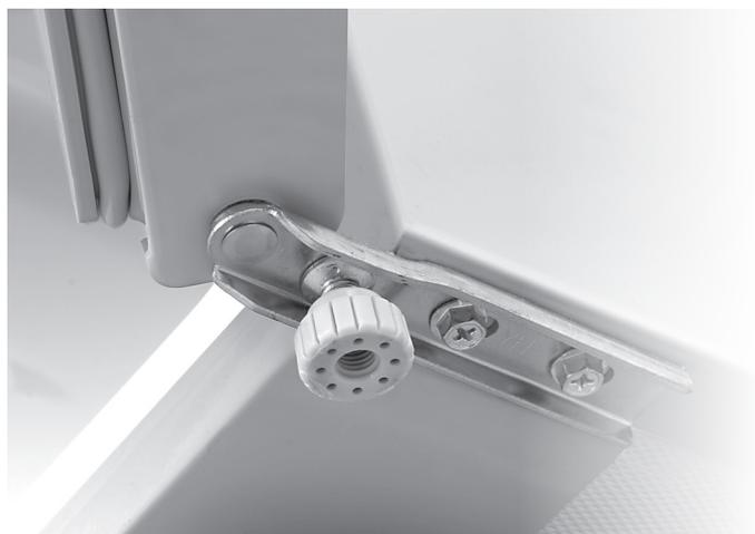
**3.** Inclinez légèrement afin que vous puissiez avoir accès au support inférieur du réfrigérateur. Dévissez les deux vis situées en bas à gauche ou à droite (selon le côté d'installation initiale de la porte) et retirez le pied du côté opposé. Une fois que les vis supérieure et inférieure et le pied opposé sont retirés, la porte sera complètement relâchée.
