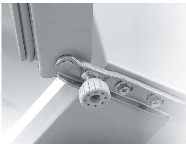
**3.** Inclinez légèrement afin que vous puissiez avoir accès au support inférieur du réfrigérateur. Dévissez les deux vis situées en bas à gauche ou à droite (selon le côté d'installation initiale de la porte) et retirez le pied du côté opposé. Une fois que les vis supérieure et inférieure et le pied opposé sont retirés, la porte sera complètement relâchée.
