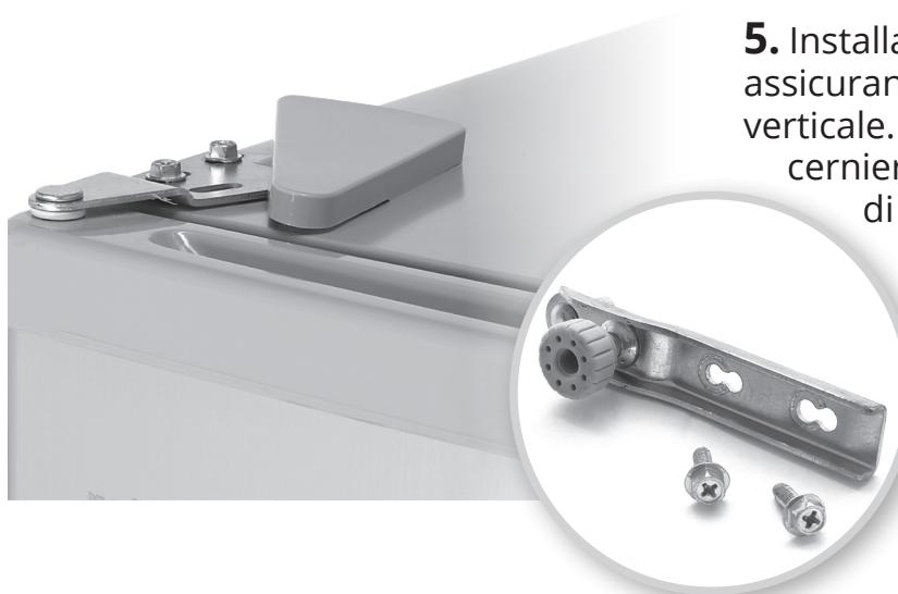
**5.** Installare la porta sul lato desiderato assicurandosi che si trovi in posizione verticale. Avvitare le due viti principali dalla cerniera inserendo nuovamente il perno di supporto. Inclinare leggermente, per un migliore posizionamento e avvitare sia la cerniera inferiore in posizione che il piedino rimosso sull'altro lato. Una volta completata la procedura di inversione della porta riposizionare il coperchio di plastica della cerniera superiore.
