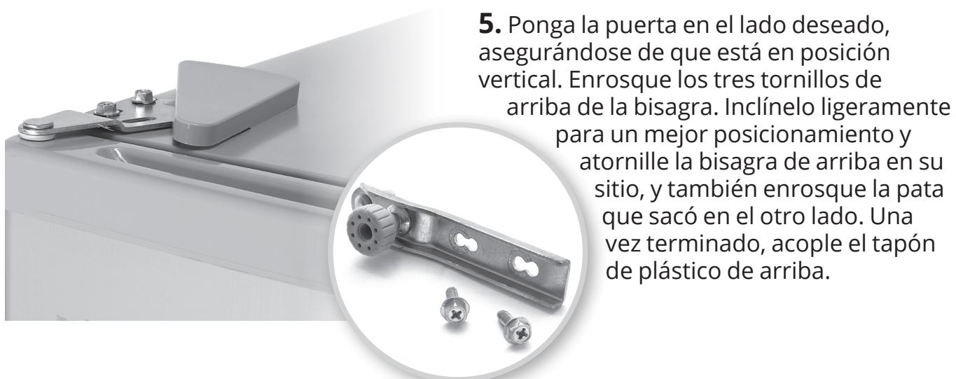
**5.** Ponga la puerta en el lado deseado, asegurándose de que está en posición vertical. Enrosque los tres tornillos de arriba de la bisagra. Inclínelo ligeramente para un mejor posicionamiento y atornille la bisagra de arriba en su sitio, y también enrosque la pata que sacó en el otro lado. Una vez terminado, acople el tapón de plástico de arriba.
