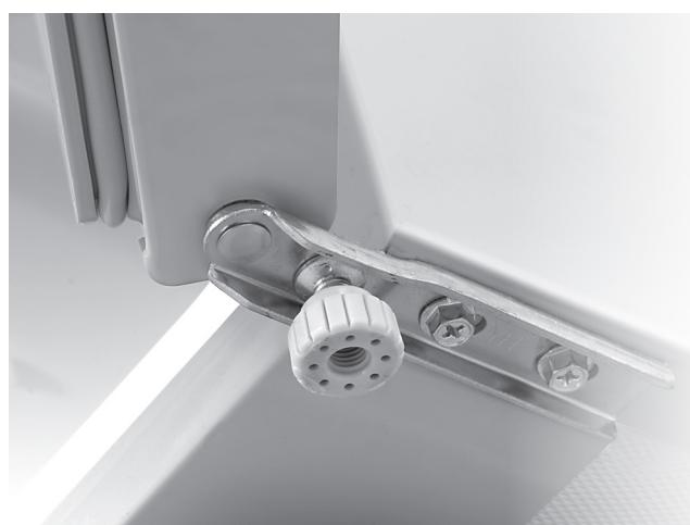
**3.** Δημιουργήστε ελαφρά κλίση ώστε να έχετε πρόσβαση στο μπροστινό κάτω στήριγμα. Ξεβιδώστε τις τρεις βίδες που βρίσκονται κάτω αριστερά ή δεξιά (ανάλογα με την αρχική τοποθέτηση της πόρτας) και αφαιρέστε το πόδι από την αντίθετη πλευρά. Μόλις αφαιρεθούν οι άνω και κάτω βίδες και το πόδι στήριξης, η πόρτα θα απελευθερωθεί τελείως.
