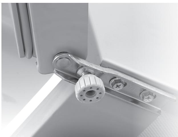
**3.** Aplecati usor pe spate pentru a avea acces la balamaua inferioara. Desurubati cele 3 suruburi si inlaturati piciorul din partea opusa. Dupa ce ati desurubat suruburile din partile superioara si inferioara, usa poate fi scoasa.
