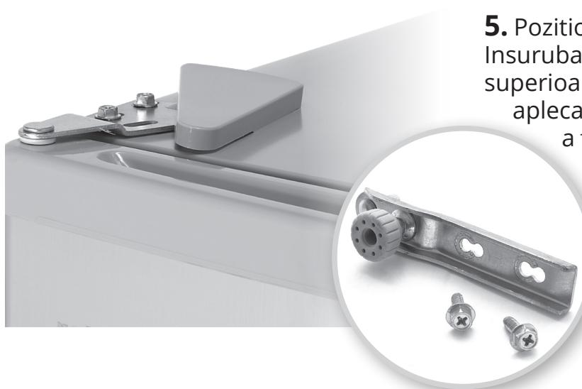
**5.** Pozitionati correct usa pe partea dorita. Insurubati cele 3 suruburi ale balamalei superioare. Pentru a pozitiona corect usa, aplecat aparatul usor pe spate pentru a fixa balamaua inferioara correct. De asemenea, in timp ce apparatul este aplecat spre spate, montati piciorul in partea opusa. Dupa ce ati terminat, montati capacul de plastic in partea superiorara.
