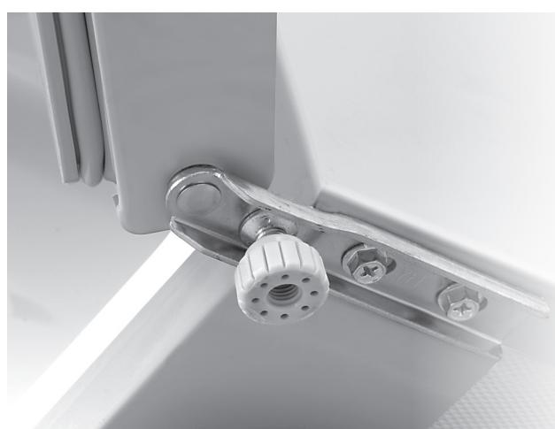
**3.** Leicht kippen, um Zugang auf den front Bodenhalter zu bekommen. Schrauben Sie die drei Schrauben unten links oder rechts (je nach der ersten Türinstallationsseite) heraus und entfernen Sie den Standfuß von der gegenüberliegenden Seite. Sobald die oberen und unteren Schrauben und auch der gegenüberliegende Standfuß entfernt sind, wird die Tür komplett freigegeben.
